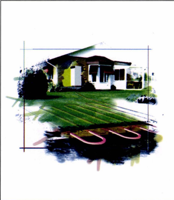
Şekil 4.128. TOPRAK KAYNAKLI ISI POMPASI TOPRAK KOLEKTÖRÜ UYGULAMASI
